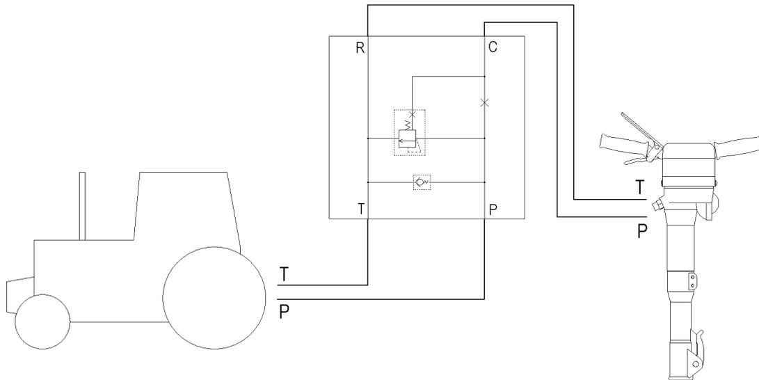
Der Ölmengenteiler läßt sich an verschiedene Antriebsquellen anschließen, wie z. B. Bagger, LKWs, Lader, Kommunalfahrzeuge, Traktoren usw. Der Ölmengenteiler reduziert die Ölmenge von diesen Maschinen, so daß sie als Antriebsquelle für die HYCON hydraulischen Werkzeuge benutzt werden können.
